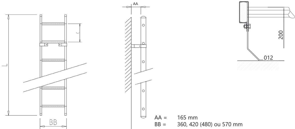
Nos échelles standard sont disponibles comme échelles simples, échelles utilisables en forme de A ou échelles extensibles (éventuellement avec corde). Les échelles simples ont une largeur de 360 mm et un espacement des échelons de 250 mm. Ces échelles sont assemblées avec un montant d'échelle rectangulaire (70 x 25 mm) et un échelon avec un dispositif antidérapant.
