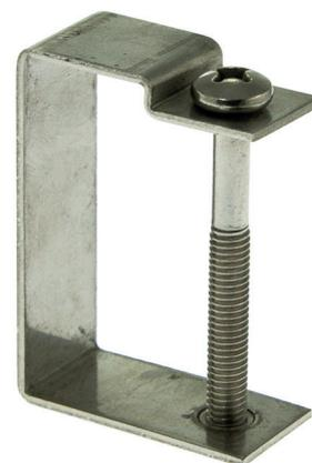
L'attache C-clip avec boulon est utilisée pour le raccordement de deux caillebotis avec mailles fermées. Les clips sont disponible en épaisseurs 25-30-38 et 50 mm.
