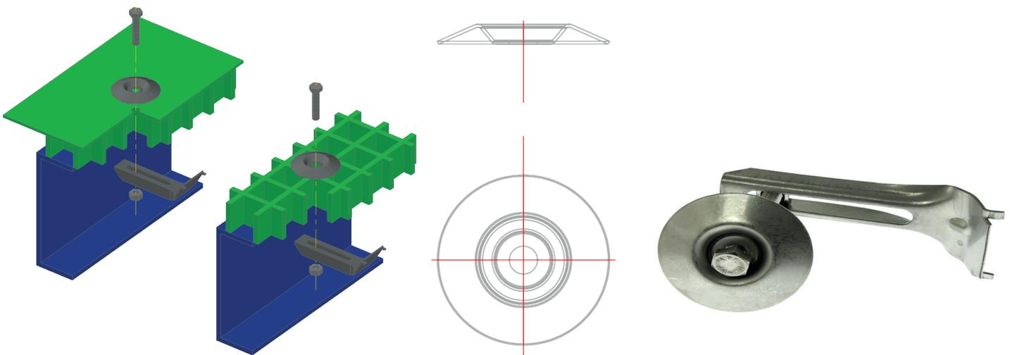
L'attache W-clip est utilisé pour la fixation des caillebotis avec mailles 20x20 et caillebotis avec plancher plein par serrage sur le profilé porteur. Ce clip est facile à installer sans percer dans la sous-structure.
